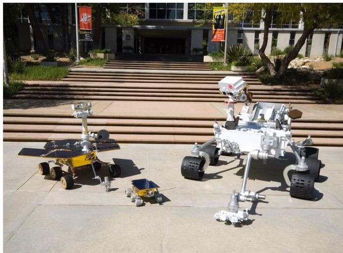
Maquettes de rovers martiens de la NASA. De gauche à droite : Mars Exploration Rover, Sojourner et Curiosity.
